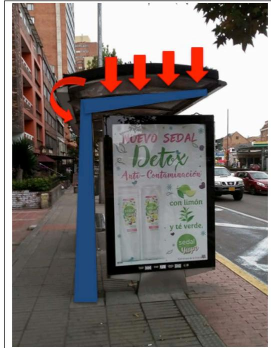
**Figura 10.** Representación de la acción de la carga del techo verde sobre la estructura del paradero
