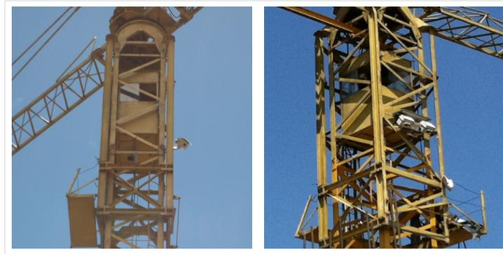
**Figura 9.** Montaje de unidad de toma de fotografías y paneles solares
