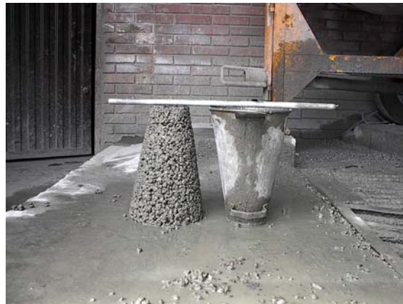
Figura 11. Asentamiento del diseño preliminar 1 (Mezcla sin adiciones).
