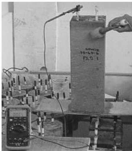
Figura 8. Medición de potenciales
