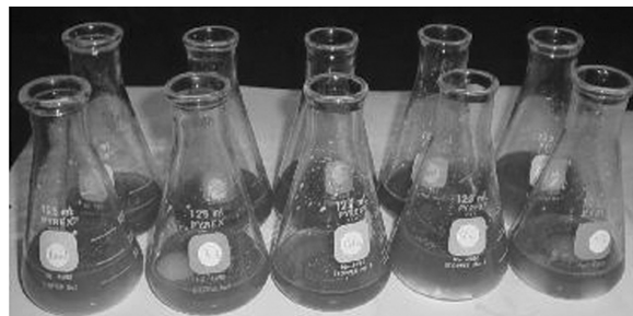
Figura 5. Determinación de Iones cloruro por Titulación Total
