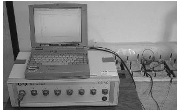
Figura 9. Equipo de corrosión ACM Gill 8 AC Instruments
