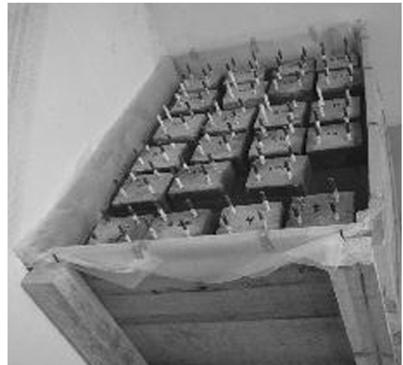
Figura 6. Ubicación de vigas inmersas en agua potable
