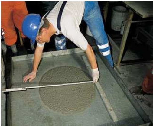
Fig. 2.- Ensayo de medición del flujo dejado por el cono.
