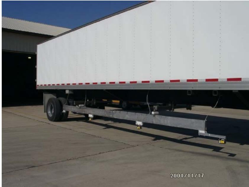
**Figura 3. Viga de aluminio con láser trasero extendido entre el doble rodado. (Cabe notar que la fotografía se tomó antes de envolver la viga de aluminio con aislamiento térmico.)**
