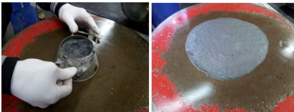
Figura 2. Ensayo de asentamiento del cono para evaluar la consistencia del UHPC
