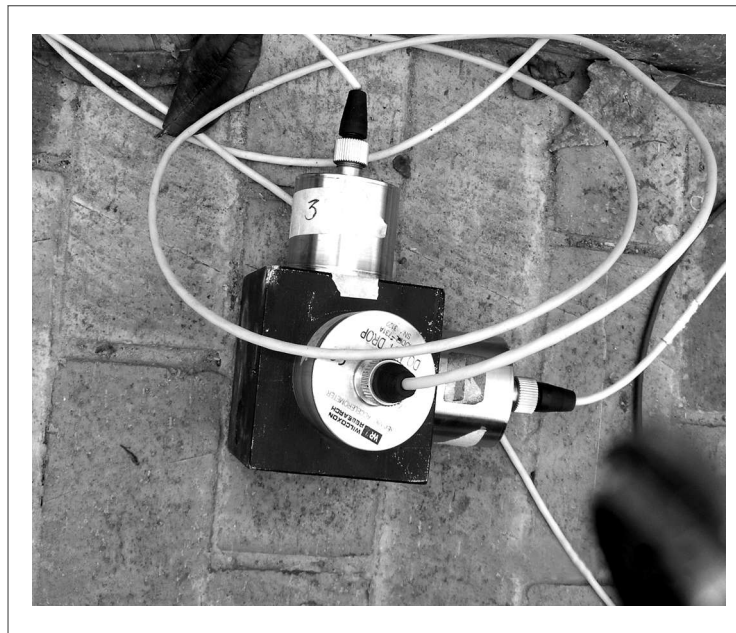
Figura 3. Acelerómetros sísmicos usados para la instrumentación Figure 3. Seismic Accelerometers used for instrumentation
