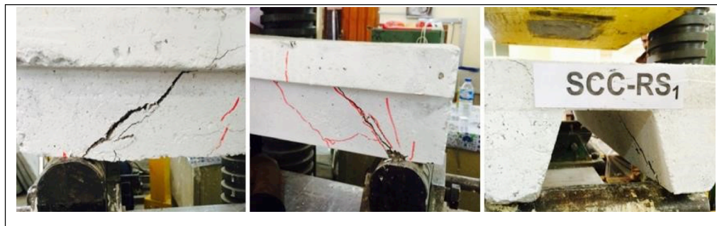
Figura 9. Modo de falla por cizallamiento del refuerzo en la nervadura
