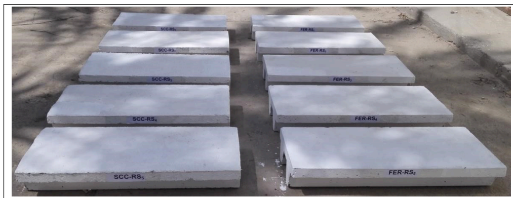
Figura 4. Paneles nervados post colado
