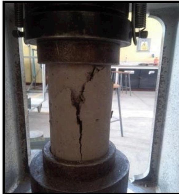
**Figure 9.** Ensayo de resistencia a la compresión.
