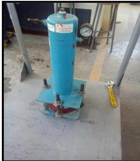
Figura 11. Ensayo de Permeabilidad para una resistencia de 210 kg/cm<sup>2</sup>. Fuente: propia
