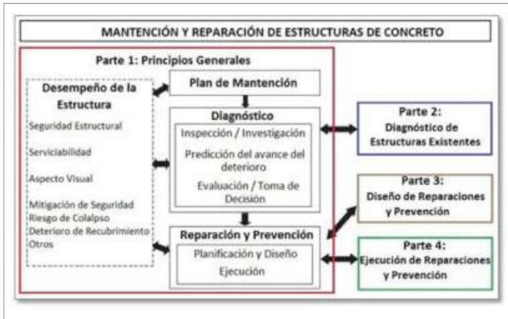
Figura 2. Flujograma de actividades de Mantenimiento y Reparación
