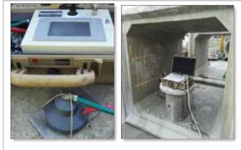
Figura 14. Equipo PermeaTorr - Permeabilidad al Aire
