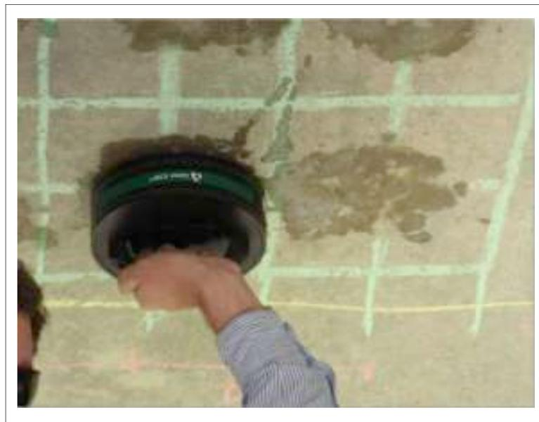
**Figura 18.** Medición de Niveles de Corrosión con equipo Icor en superficie inferior de Losa Prefabricada
