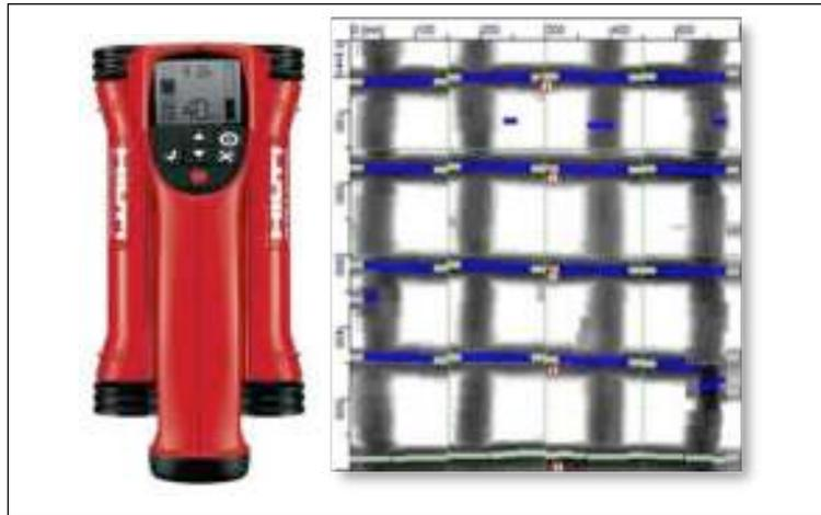
Figura 5. Equipo FerroScan PS200 – Localización armaduras
