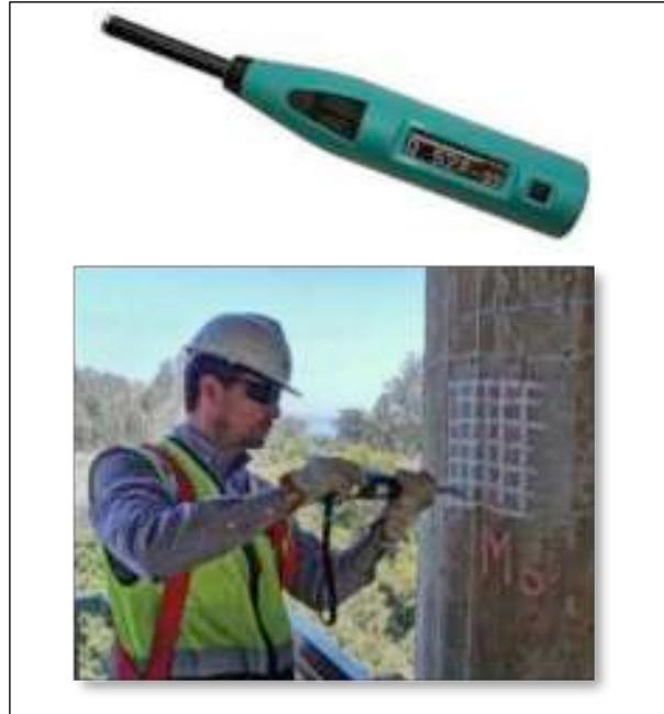
**Figura 7.** Martillo Schmidt – Resistencia del Hormigón
