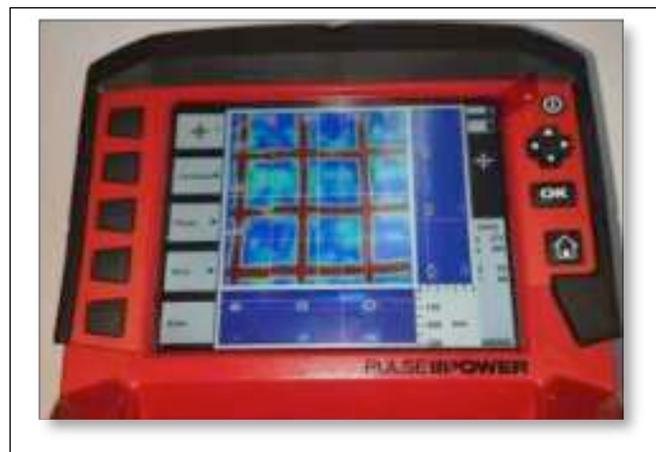
Figura 6. Equipo FerroScan PS1000 – Información de Armaduras
