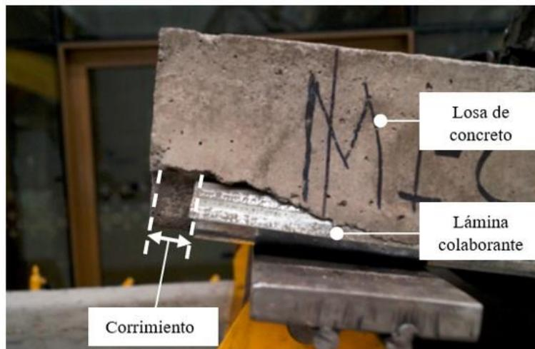
**Figura 12.** Deslizamiento o corrimiento longitudinal probeta grupo C
